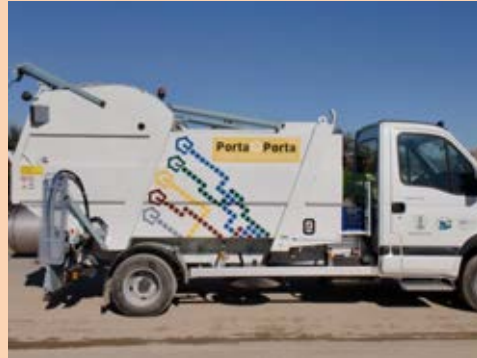
Vehículo de recogida monomaterial, de 7 m 3 , utilizado para la recogida puerta a puerta de diversas fracciones selectivas (Vidrio, Papel-cartón, Envases Ligeros, FORS) y Resto.
