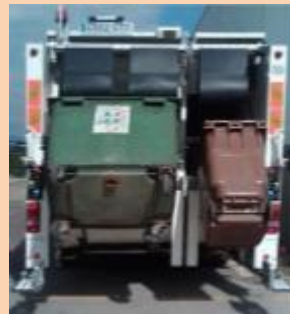
Vehículo bicompartimentado para la recogida selectiva de la FORS (30%) y de la Fracción Resto (70%). Vista lateral (izquierda) y Vista posterior (derecha)
