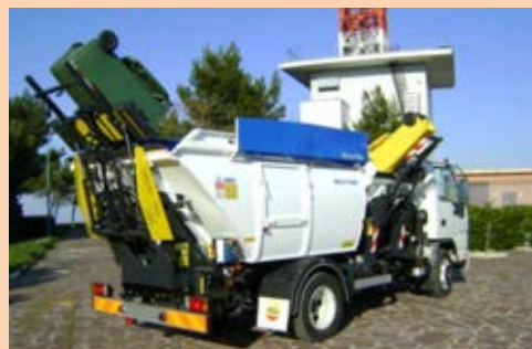
Vehículo para la recogida puerta a puerta, con dos compartimentos, de carga lateral y posterior.
